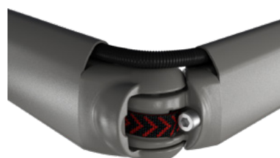
4 Tendon bionique et gaine renfermant les câbles électriques dans les bras
