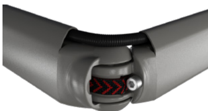
8) Tendon bionique et gaine renfermant les câbles électriques dans les bras
