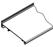
Profilé de raccordement au mur avec joint à brosse intégré
