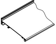
Profilé de raccordement au mur avec joint à brosse intégré
