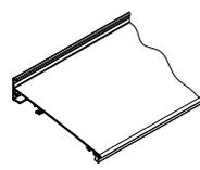
Profilé de raccordement au mur avec joint à brosse intégré pour montage avec tôle de protection
