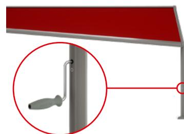
4 Lambrequin déroulable <sup>1)</sup>, commande par manivelle, phase de déroulement
